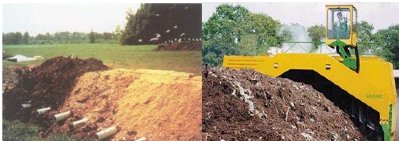
Utilaj special pentru umezire și întoarcere a compostului Sistem de aerare a compostului
